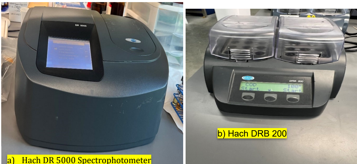
Figure 31. a) Hach DR 5000 Spectrophotometer and b) Hach DRB 200
